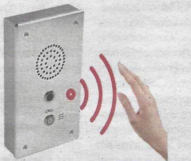
À L'HEURE DU "SANS CONTACT", tous les objets usuels se parent de fonction anti-virus : clés, poignées de portes, casquettes à visière... Avec son kit mains libres TM 450, A2S propose « une double garantie » : la protection d'étanchéité IP65 et un boîtier anticorrosion en acier inox.
