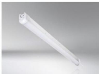
La gamme des luminaires linéaires BLX possède un haut rendement avec un flux lumineux de 8 245 lm à 8 484 lm et une efficacité lumineuse allant jusqu'à 143 lm/W. Disponibles en deux températures de couleur (4000K, 5000K), les linéaires LED intelligents BLX sont étanches (IP66) et résistants (IK10). Ils fonctionnent sur variateur (0% à 100%) à des températures de -20° à +40°. Leur durée de vie L80 est de 80 000 heures. Ils sont garantis 5 ans.
