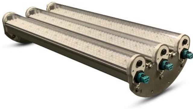
WinAe de EAS Solutions , une gamme de luminaires LED à très haut rendement, modulable et très économe en énergie, est destinée à l'éclairage industriel de grande hauteur. Équipée d'un système de gestion thermique intégré et de LED Osram à très haut rendement, WinAe possède une efficacité lumineuse de 150 lm/W et une durée de vie de 100 000 heures.
